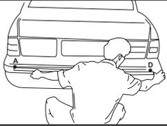
A. Messen Sie den Abstand zwischen den Sensoren A & D und berechnen Sie gleichen Abstände zur Markierung B & C.
