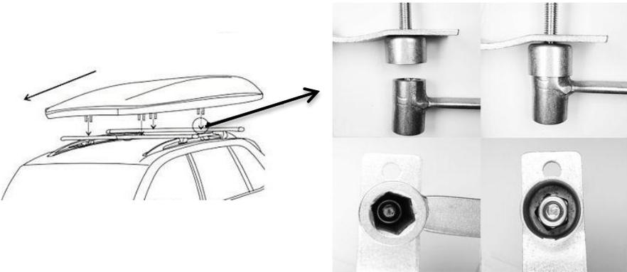
5. Überprüfen Sie die Installationsschrauben und -mutter nach der Installation erneut. Vergewissern Sie sich vor dem Fahren, dass diese fest sitzen.
