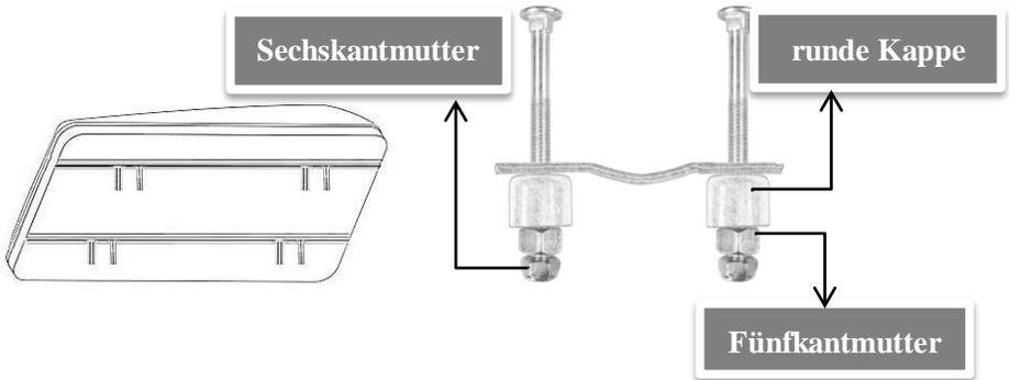
3. Laden Sie das Zelt auf die Querträger des Autodachs. *Die Querträger müssen sich jeweils zwischen 2 Schrauben befinden.*
