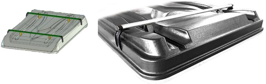
4. Entfernen Sie die Schrauben an der Seite des Dachs und bringen Sie dort die Halterungen mit diesen Schrauben an.
